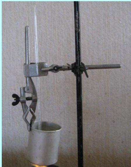
Рис. 4. Экспериментальная установка для определения удельной теплоты сгорания и зольности пеллет.
