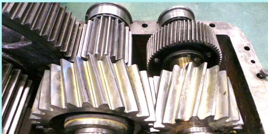
Рис.2 Применение зубчатых колес с зацеплением Новикова в редукторах
